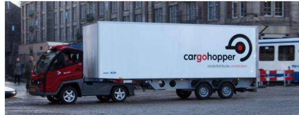
Abbildung B 15: Sattelzugversion des Cargohoppers in Amsterdam mit hydraulischer Laderampe, 9 m Länge 75 km Reichweite und 2,8 t Nutzlast (10 Europaletten)<sup>65</sup>
