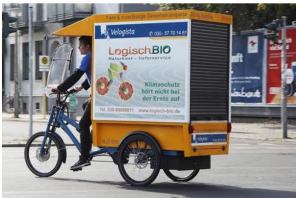
Abbildung B 17: Elektro-Cargo-Velo von Velogista mit einer maximalen Zuladung von 250 kg<sup>70</sup>
