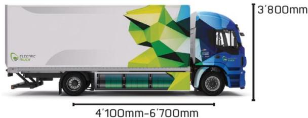
Abbildung B 14: Vollelektrischer E-FORCE 18 t mit einer Reichweite von bis zu 350 km auf IVECO Stralis Basis<sup>64</sup>
