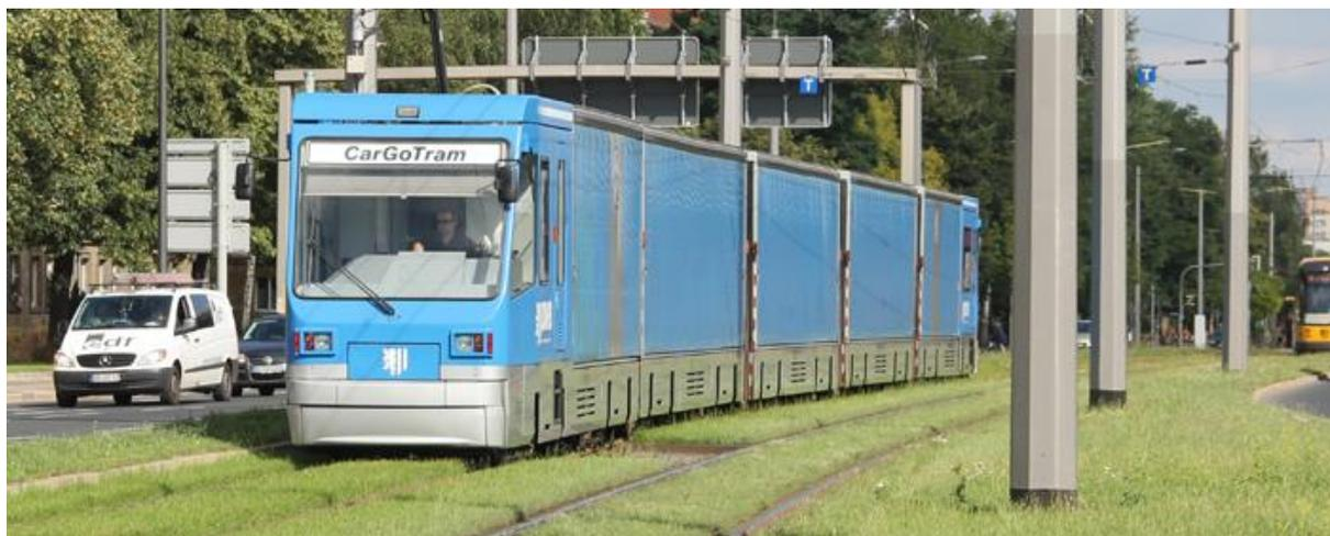
Abbildung B 21: CarGoTram in Dresden mit einer maximalen Zuladung von 60 t bzw. 214 Kubikmetern<sup>79</sup>
